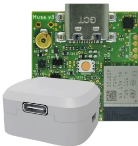
Rysunek 2: Czujnik IMU MuseV3 zastosowany w projekcie EDATS (źródło: 221e Srl).
