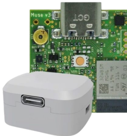
Figura 2: Sensore IMU MuseV3 utilizzato nel progetto EDATS (fonte: 22le Srl)
