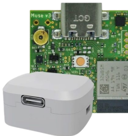
Figure 2: Capteur IMU MuseV3 utilisé dans le projet EDATS (source : 22le Srl)
