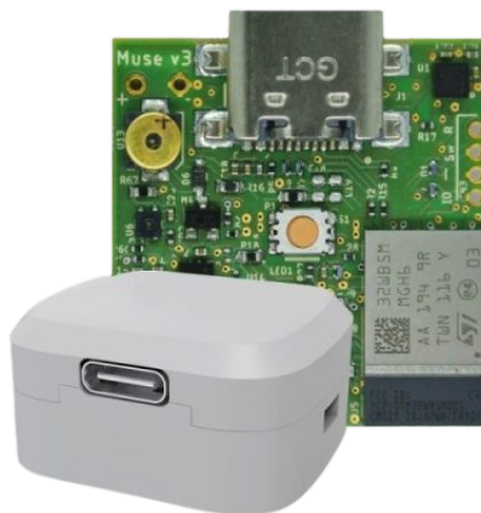
2. ábra: Az EDATS projektben használt MuseV3 IMU érzékelő (forrás: 221e Srl)
